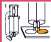
Retirer le bouchon amovible du piston nécessaire à la fermeture ultérieure. Casser l'extrémité du doseur. Presser sur le piston jusqu'à l'obtention de la quantité de colle souhaitée. Pour fermer, essuyer les 2 extrémités du doseur et boucher soigneusement.
