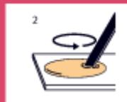
Mélanger soigneusement les 2 composants (au moins 30 secondes) jusqu'à l'obtention d'une pâte homogène.
